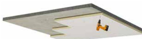
2 Pré-perçer la sous-face du plancher au travers du panneau.
