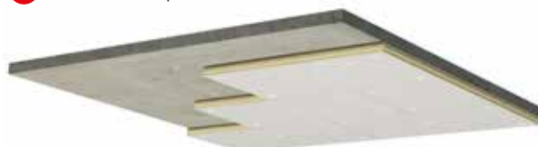
3 Fixer mécaniquement les panneaux à l'aide de chevilles (2 fixations par panneaux de dimensions 1 200 x 600 mm disposées en diagonal) : • Pour les corps creux, utiliser des chevilles de type HILTI clous IDP-L ou équivalent • Pour les corps pleins, utiliser des chevilles de type HILTI clous IDP ou SPIT clous CI ou équivalent
