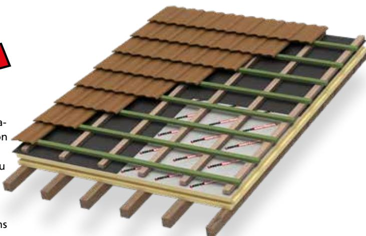
Le système IKO enertherm sarking est utilisé pour l'isolation par l'extérieur des toitures inclinées via l'application de panneaux d'isolation **IKO enertherm ALU NF** sur la face extérieure du toit (sur les chevrons, la charpente ou le voligeage). **IKO enertherm ALU NF** est un panneau d'isolation avec une âme en mousse rigide de polyisocyanurate 100 % sans CFC, HCFC ou HFC, revêtu sur les deux faces d'un complexe multicouche d'aluminium sans présence de marquage étanche au gaz.
