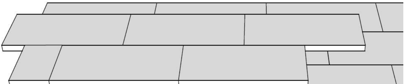
Figure 2 : pose des panneaux isolants en quiconque (joints décalés) : cas de la pose en 2 lits
