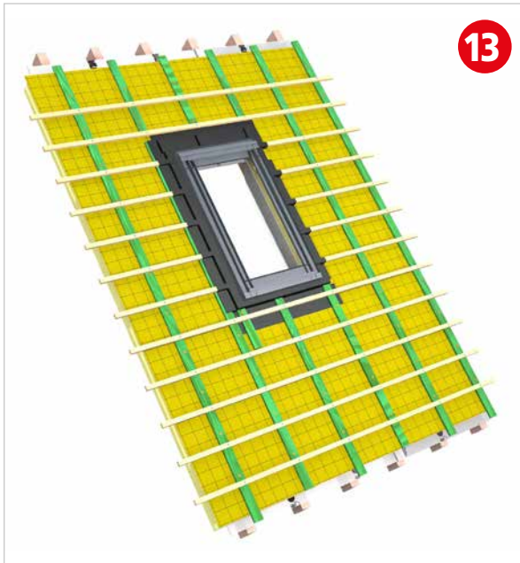
Placez et fixez le collet de sous-toiture en about sur la charpente de toiture et la feuille de sous-toiture.
