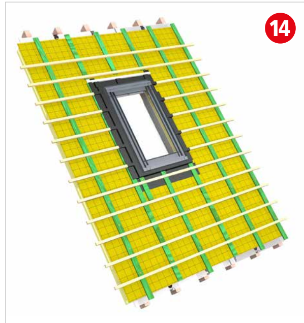
Placez la barbacane dans l'évidement prévu au-dessus de la tabatière. Adaptez toujours la largeur de la barbacane aux dimensions de la tabatière.
